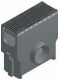
Odtoková vpust s pozinkovaným košem, s litinovým krytem štěrbina SW 6 mm, černým, třída C 250, s aretací
